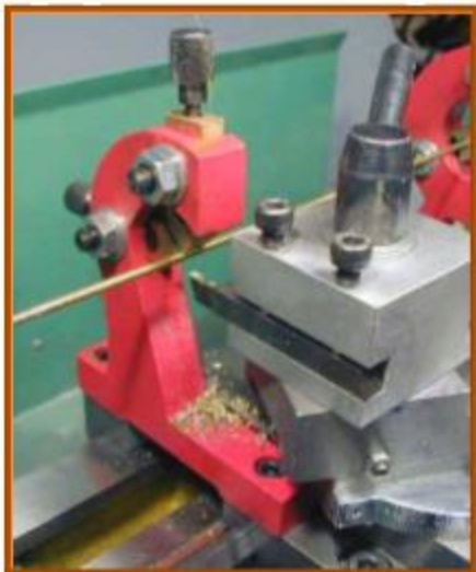
Lunete mobile sau fixe – utilizate pentru piese cu rigiditate mică
