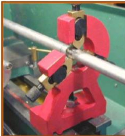
Lunete mobile sau fixe – utilizate pentru piese cu rigiditate mică
