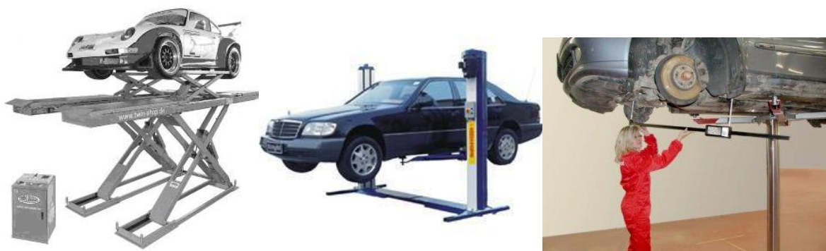
a - elevator foarfecă; b - elevator cu bare; c - aparat pentru măsurarea dimensiunilor Tipuri de elevatoare.
